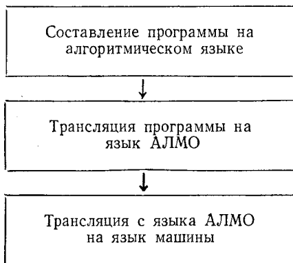
Рис. 1.9. Схема применения машинно-ориентированного языка АЛМО
